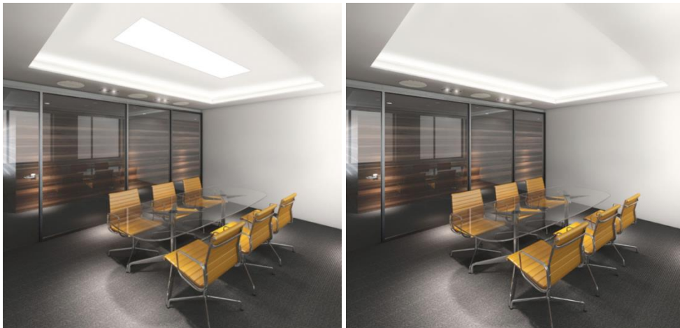
Figur 72, ulike løsninger for belysning i møterom, tv. kombinasjon av direkte og indirekte belysning, th kun indirekte belysning
