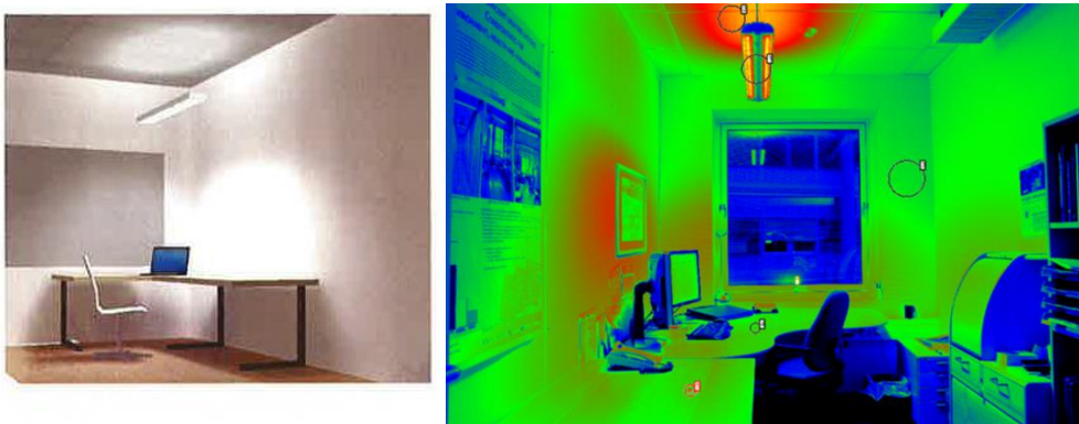
Figur 29, Beregnet og målt lysnivå på en kontorarbeidsplass. Bildet til høyre er tatt med luminanskamera ( Norconsult)
